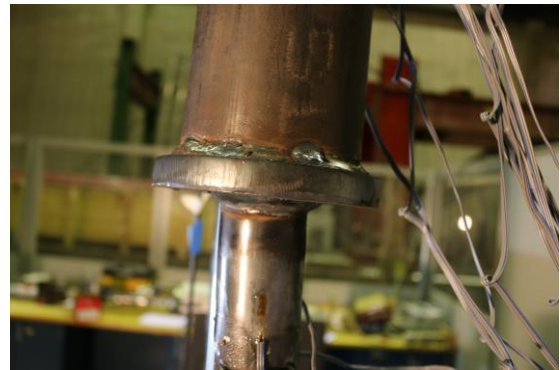
(d) Rotation of the lower edge tube (Fixed end)
