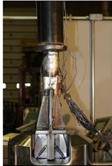
(d) Out-of-plane rotation of the bottom tube
